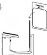
Placer le panneau **Trap-ID™** dans l'emplacement de support, le côté englué doit être positionné face à la caméra.
